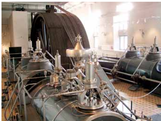
Ångmaskinen som drev elgeneratoren vid Finlaysons fabrik.
